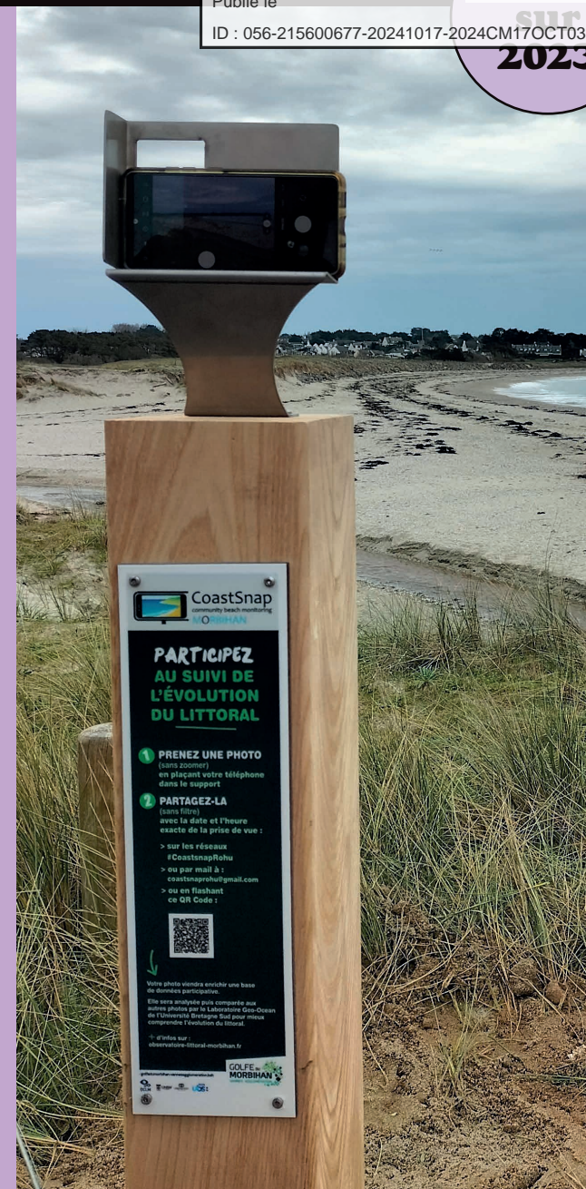
Pour observer la montée des eaux, des stations Coastsnap d'observation sont installées sur différentes plages du territoire.
